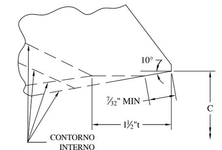
Fig. 3.- Extremo soldable para ensamblar con arillo de respaldo continuo de planos inclinados (contorno interno)
