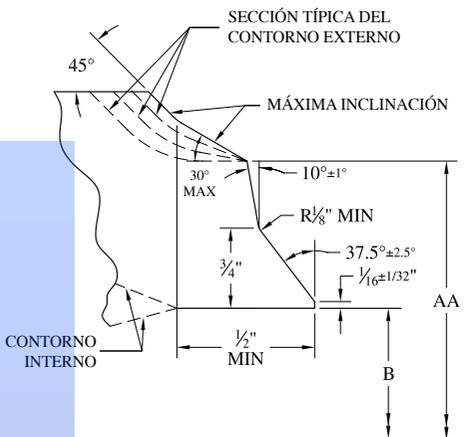
Fig. 1B.- Extremo soldable para ensamblar con arillo de respaldo bipartido para espesores de tubería mayor a "t" 7/8"
