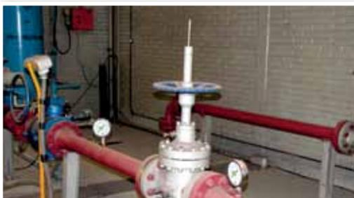
**Circuito de Pruebas.**- Se cuenta con un laboratorio completo para la validación de diseño, simulando las condiciones de operación más severas. La duración de una prueba es de 4 a 6 meses, tiempo en el cual se realizan de 3,000 a 5,000 ciclos (apertura y cierre).
