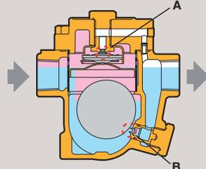
Una vez que todo el condensado y aire inicial fueron descargados, el condensado caliente calienta el elemento X y cierra el puerto (A) antes que el vapor pueda escapar. El condensado que simultáneamente ingresa a la trampa es descargado continuamente por el puerto (B).
