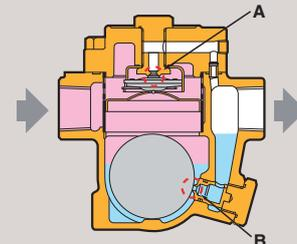
Cuando el condensado se descarga del cuerpo de la trampa, el flotador cierra el puerto (B) el cual queda cerrado herméticamente por el nivel del agua. La sección superior que está llena de vapor mantiene al puerto (A) cerrado. La trampa está completamente cerrada, para prevenir cualquier fuga de vapor.
