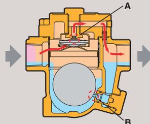
El aire o el condensado retenido que entra en la trampa bajan la temperatura de la trampa y contraen al elemento X. El puerto (A) instantáneamente abre para descargar el aire. Cuando el condensado a alta temperatura ingresa, el elemento X se expande y cierra el puerto (A).
