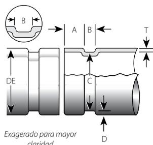
ESPECIFICACIONES DE RANURADO POR LAMINACIÓN DE TUBERÍAS DE COBRE @
