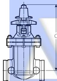
LÍNEA CENTRAL DE LA VÁLVULA DE COMPUERTA NRS (SE MUESTRA SERIE 772H)
