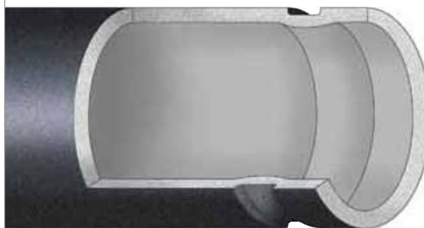
En la ilustración se muestra una ranura laminada en una tubería de acero Cédula 40. El pequeño surco que queda en la pared interior de la tubería no afecta de manera significativa a la presión o el caudal.
