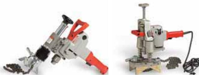
Corte orificios de 4½"/108 mm con rapidez y precisión en la mitad de la tubería con las herramientas para corte de orificios Victaulic, véase la pág. 11-6.
