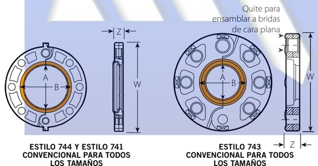
Para un sellado eficaz, el área anaranjada de la cara acoplada no debe tener perforaciones, ondulaciones ni deformidades de ningún tipo.
